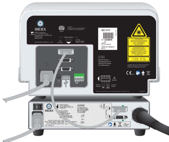
Cable de la caja de control
