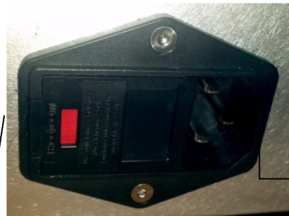
Zásuvka napájecího kabelu
